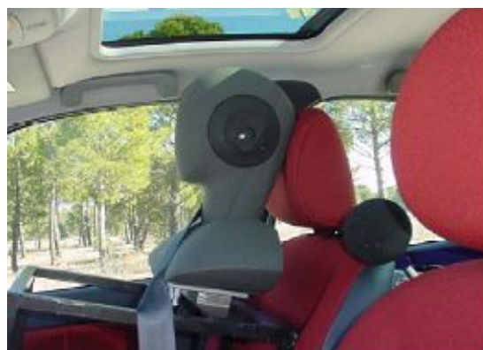
그림 4-33 실내 소음 측정 모습
