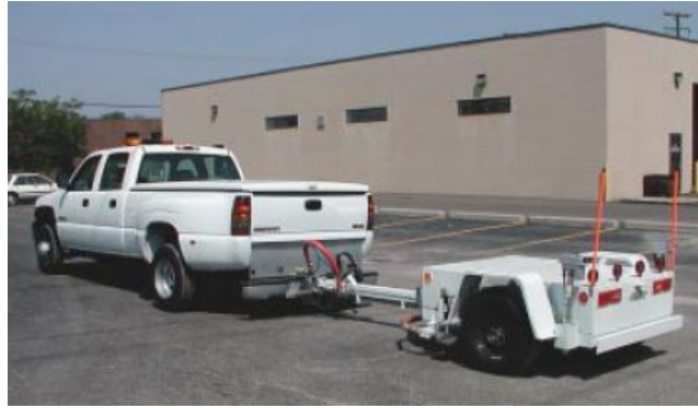
그림 4-24 미끄럼 저항성 측정 장비
