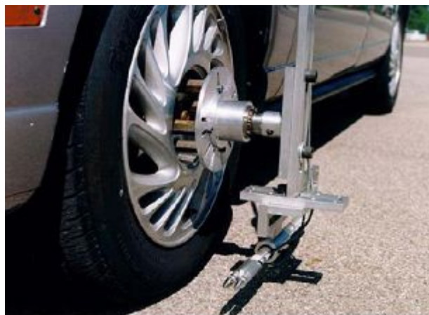
그림 4-30 음의 세기 측정용 탐침기의 탑재 모습
