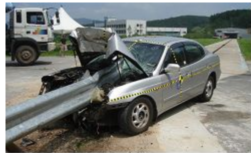
단부장치부재로 인한 충돌 (Simulated Test, 한국도로공사)
