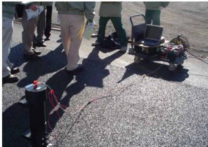
그림 4-31 임피던스 튜브를 이용한 포장 흡음률 측정
