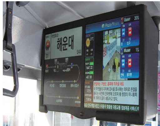
스마트BIT(상), 차내장치(하)는 정류소와 버스에 설치되어, 이용자 맞춤형 센터와 양방향 통신을 통한 실시간 맞춤형 교통·부가정보를 제공한다.
