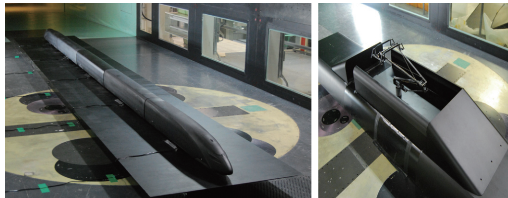
5량 모델 풍동 실험 모델(좌), 팬터그래프 및 팬터그래프 하우징 풍동실험 모델(우).
