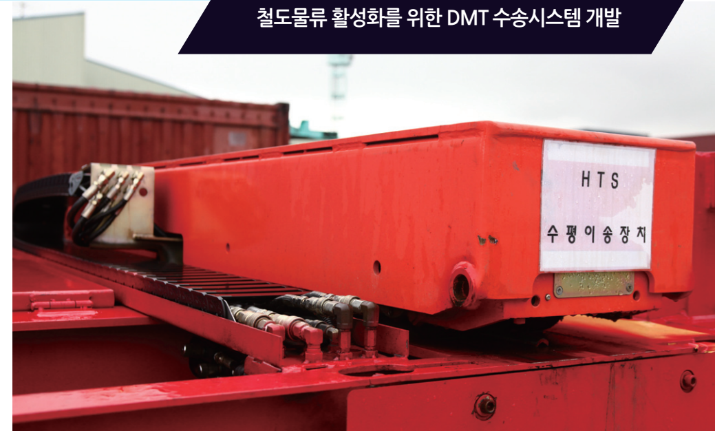
수평이송장치(HTS ; Horizontal Transfer System)의 모습.
