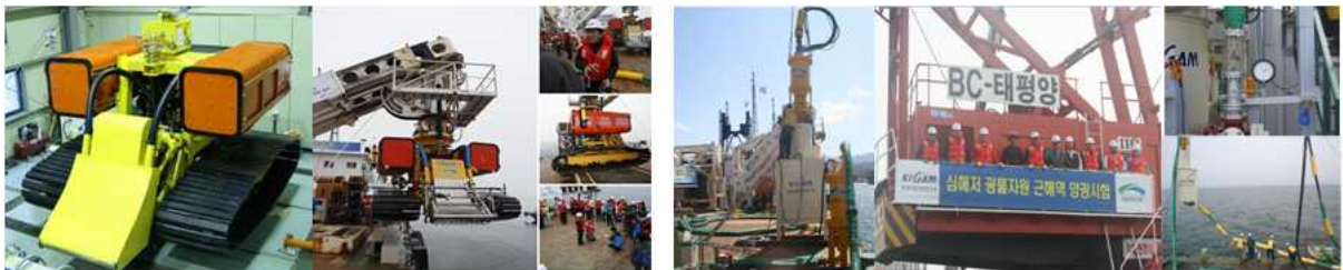
<망간단괴 근해역 통합채광 실증시험 : 자항식 집광로봇 미내로(좌) 및 양광시스템(우)>
