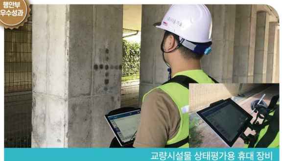
교량시설물 상태평가용 휴대 장비 E-Pad 기반 교량시설물 안전점검 시스템
