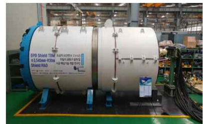
< 공동구 급곡구간 시공장비 >
