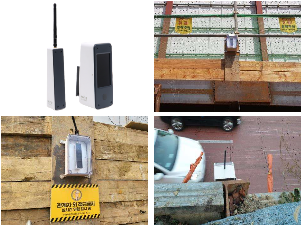
그림11. AIoT Real-time risk alert&monitoring system(주식회사 케이씨티이엔씨)
