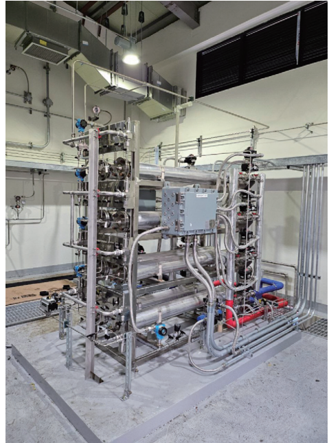
* 수소저장합금의 온도에 따른 수소 저장 및 방출 특성을 이용하여 수소를 저압에서 흡수하고 고압에서 방출하는 수소저장합금 압축기의 모습으로 기계적인 움직임이 없어 소음이 없고 안전함
