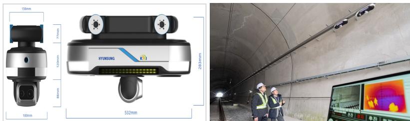
〈개발 이동형 영상감시시스템 철도연 오송시험선 설치현황〉
