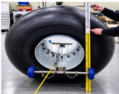
〈대형 하수관 보수 팩커 팽창 테스트〉
