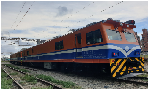
〈대만TRC 전차선 고속검측차(검측시스템 탑재 전용검측차)〉
