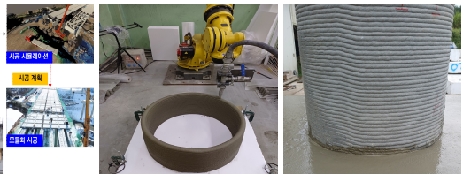
〈로봇암을 이용한 디지털 디자인 구현 form free 생산기술〉
