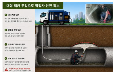
〈작업자를 통한 하수관 보수(인력 투입)〉
