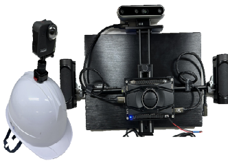
〈AI 기반 실시간 자동 철근 간격 측정 시스템 하드웨어〉
