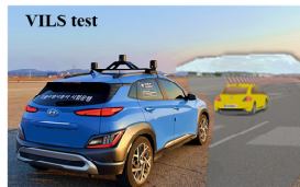
〈자율주행차량의 VILS시험 및 실차 시험〉
