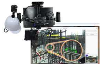
<Virtual tour를 활용한 실시간 철근간격 측정시스템>
