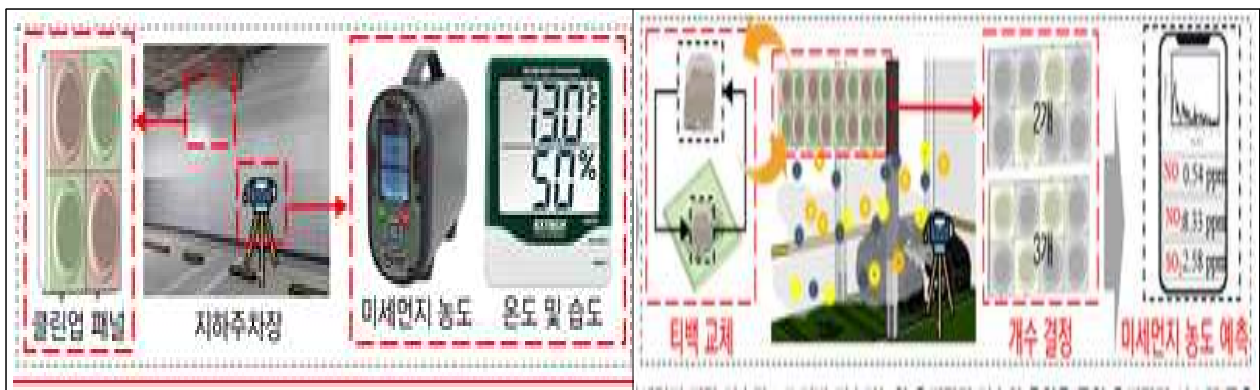
<지하주차장 환경에서 미세먼지 농도 측정 및 데이터확보>
