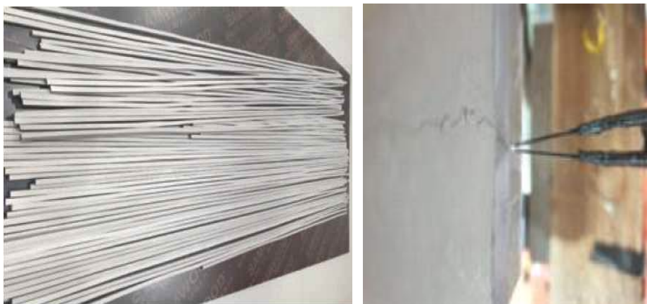
[그림] 철계-형상기억합금(좌)과 이를 이용한 인장재 재긴장(우) 전경
