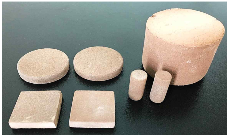
[그림] 마이크로파 소결 기술로 제작된 인공월면토 소결체(KLS-1)
