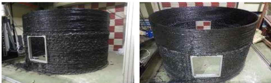
[그림] 고분자 바인더 활용 3D 프린팅을 통해 제작된 지름 3m, 높이 2m 구조물
