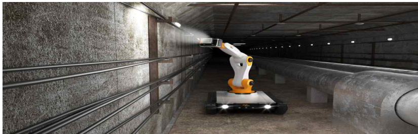
[그림] 지하공간에서의 자율주행형 점검 로봇 테스트 모습
