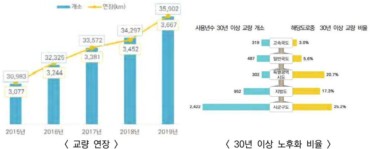
[그림] 국내 교량 연장 및 30년 이상 노후화 현황('15~'19)
