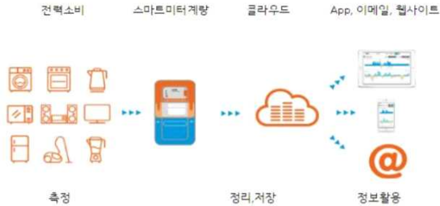
[그림] Smart Meter를 통한 전력계량
