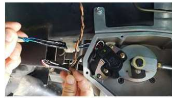
27. 클러치 모터 배선 결선 작업
