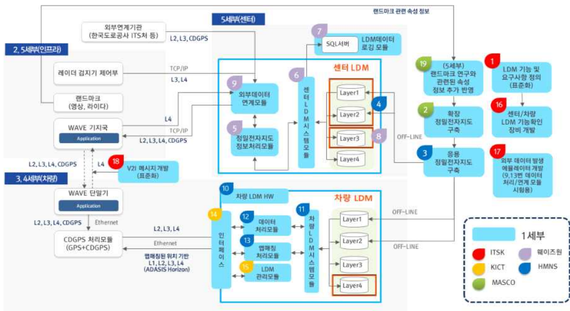
<그림 18> 자율협력주행을 위한 LDM 및 V2X 기반 도로시스템 개발 기술 개념
