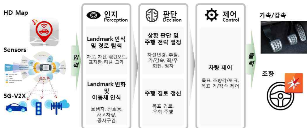
<그림 41> 자율주행차량 판단, 제어 시스템
