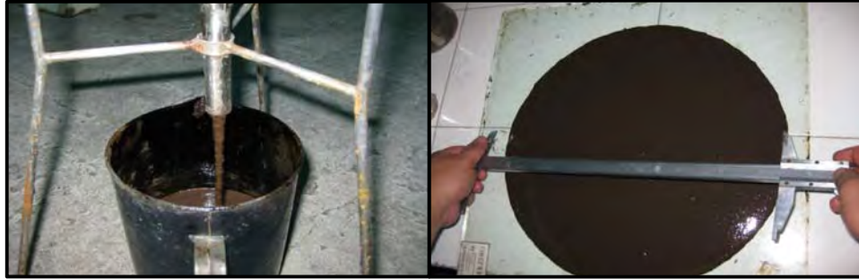
[그림 1-3] 흐름성 및 작업성 시험
