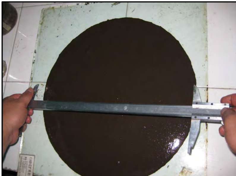
[그림 3-1] 복합 아스팔트계 안정재료 개발을 위한 유동성 시험
