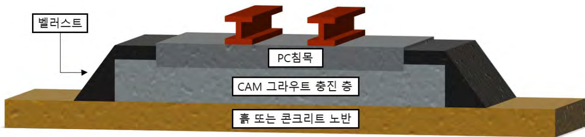
[그림 2-12] 일본 CAM을 이용한 기존선 생력화
