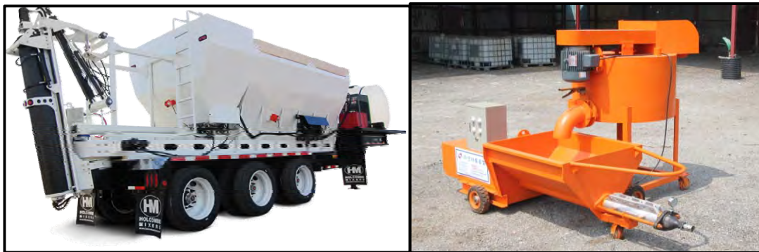
[그림 1-8] 도상 안정 재료의 계량, 혼합 및 주입 장비 개발
