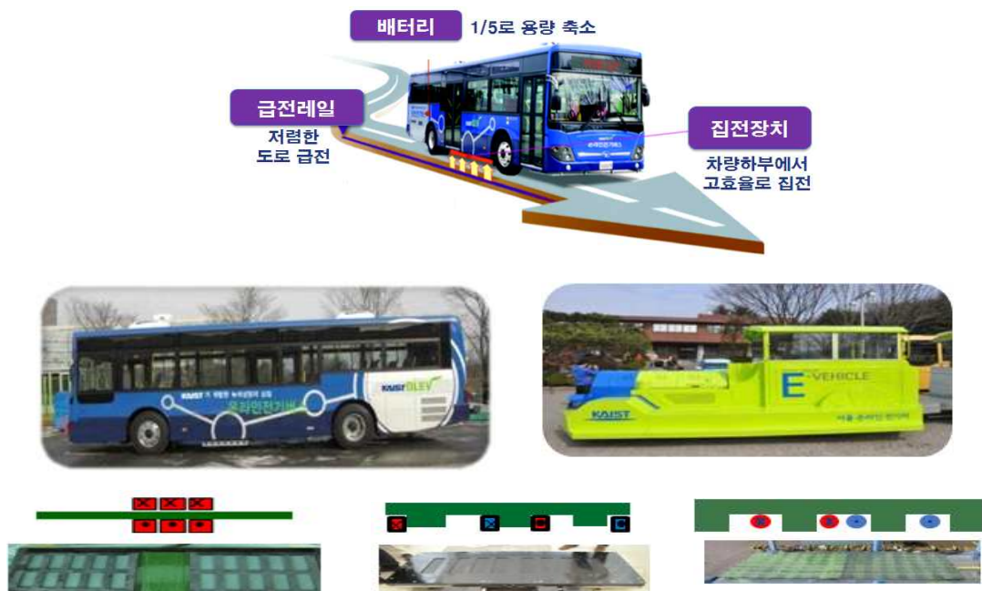
<그림 24 KAIST가 개발한 온라인전기자동차 및 집전구조>
