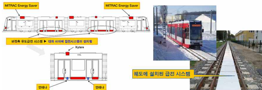
<그림 23 Bombardier의 PRIMOVE 시스템 및 독일 Bautzen의 시험라인>
