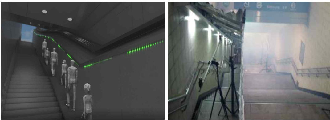
그림 2-3-13 한국철도기술연구원의 계단형 접이식 스마트 대피통로 개발 사례
