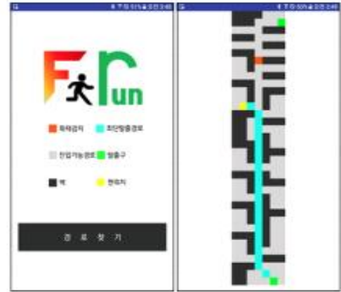
그림 2-3-9 인공지능 기반 화재대피로(좌, 기계연), 스마트폰 기반 화재대피로(우) 유도 시스템
