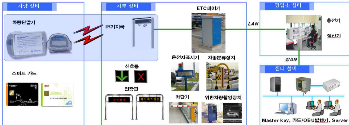
<그림 2> 하이패스 시스템 구성 설비
