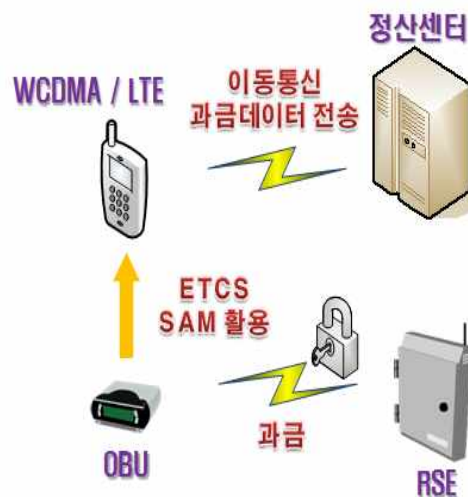
<그림 23> ETCS SIM과 SAM을 활용한 시스템 구성
