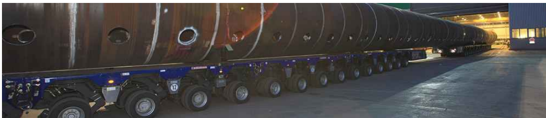
그림 32. 고가의 특수대차를 이용한 대형 강관 타워구조물의 운송
