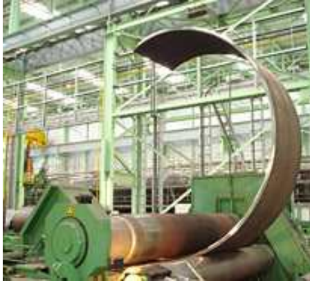
후판을 이용한 강관 제작
