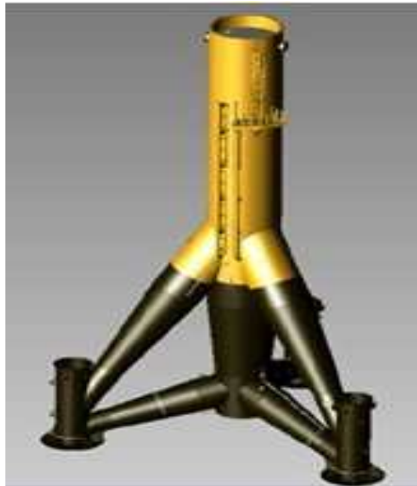
그림 39. 해저 기초로 활용된 Tripod 강재 구조물 사례 (타워구조에도 적용가능함)
