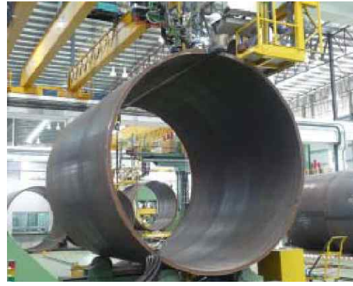
특수 용접장치(External submerged arc)를 이용한 타워용 대형강관의 조관
