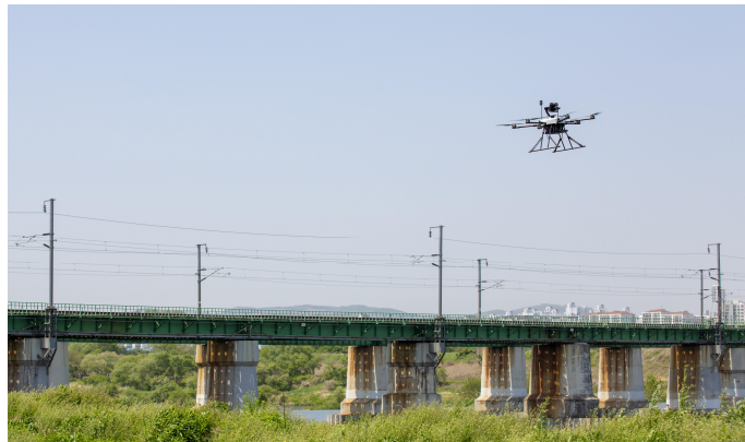
[그림] 드론과 시기술을 활용한 철도시설물 자동화 점검시스템
