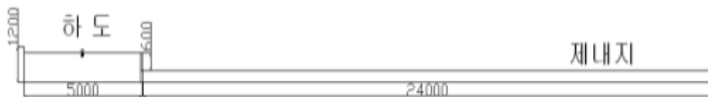
[그림 2-4] 제방붕괴 및 제내지 범람실험장치
