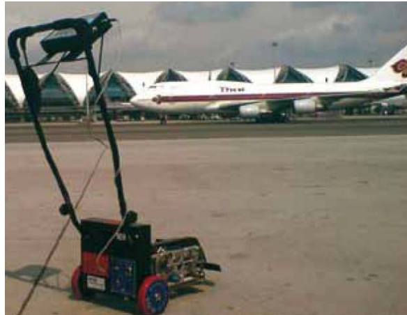
<그림 2.40> Walking Profiler G2
