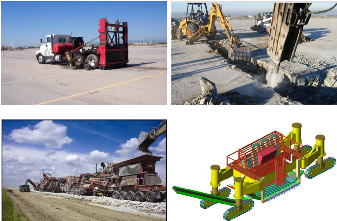
<그림 2.22> 도로 및 공항 포장의 현장 Recycling 장비
