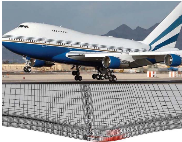
<그림 3.3> 불연속면에서의 항공기 하중 작용(Al-Qadi et al, 2008)
