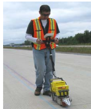
<그림 2.39> (a) SUPRO 조사장비 (b)조사 예시
