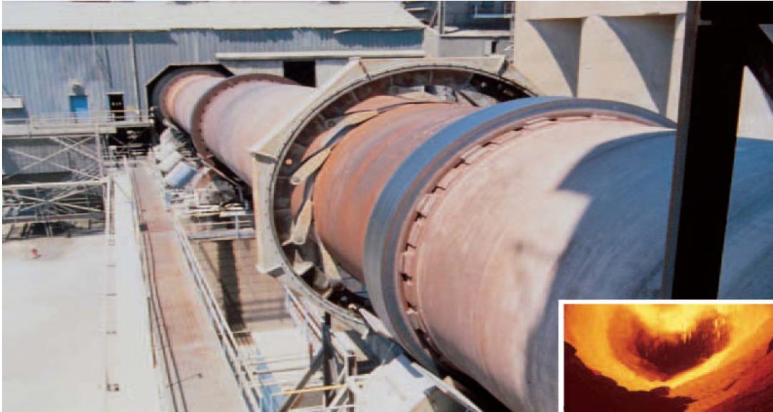
<그림 3.4> 시멘트 클링커 생산을 위한 킬른(kiln)공정
