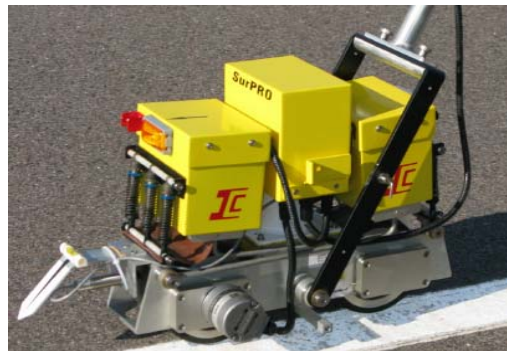
<그림 2.39> (a) SUPRO 조사장비 (b)조사 예시
