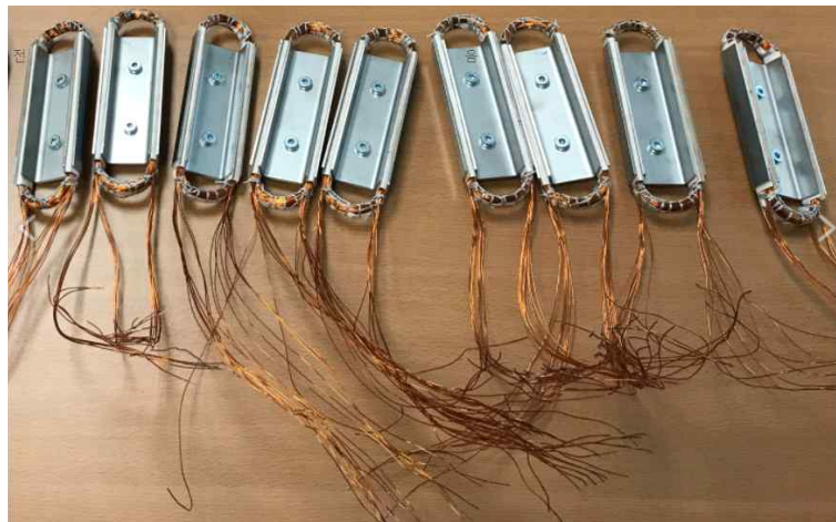
< 그림 3. 권선 사이의 전압 분포에 대한 고전압 구배의 영향을 연구하기 위해 구현 된 "Motorettes" > (Electric drives improved in density, efficiency and reliability, www.electricmotorengineering.com .p3.)
