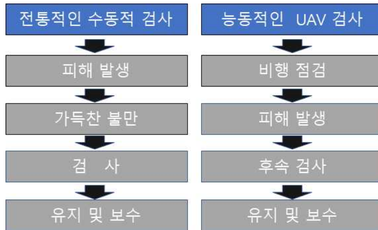
그림 1. UGA에서의 육안 검사와 UAV를 사용하여 제안된 검사 방법의 비교. 전통적으로 불만사항이 제기되면 피해가 해결되기까지 수개월간 추가 피해가 있을 수 있다. UAV를 사용하면 검사가 더 자주 수행될 수 있으므로 건물 내부 영향을 미치기 전에 외부 손상을 발견할 확률이 높아진다.
