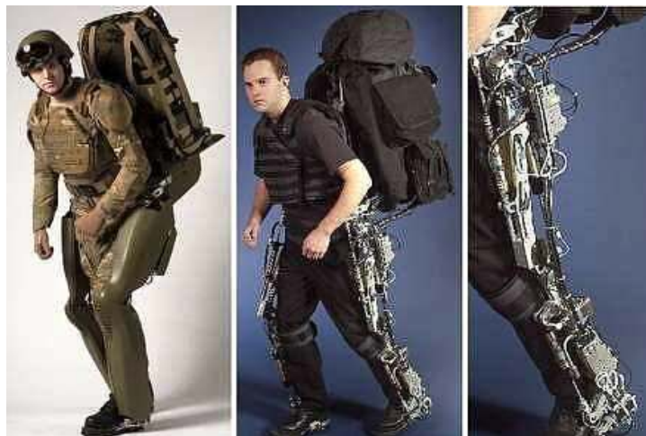
그림 2-29. Berkeley Lower Extremity Exoskeleton (University of California Berkeley)
