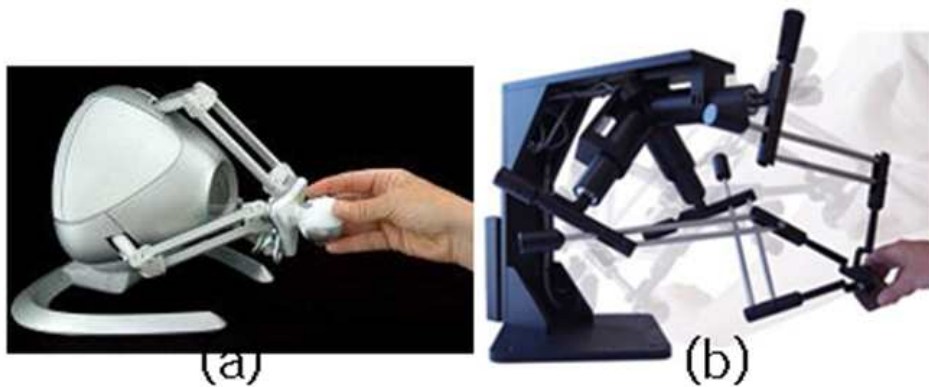
그림 2-24. Novint사의 Falcon, MPB Technologies사의 Cubic
