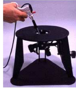
그림 2-23. Sensable Technology사의 Phantom과 역감 제시 장치를 이용한 복강경 수술 시뮬레이터 장치
