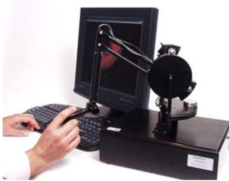
그림 2-23. Sensable Technology사의 Phantom과 역감 제시 장치를 이용한 복강경 수술 시뮬레이터 장치
