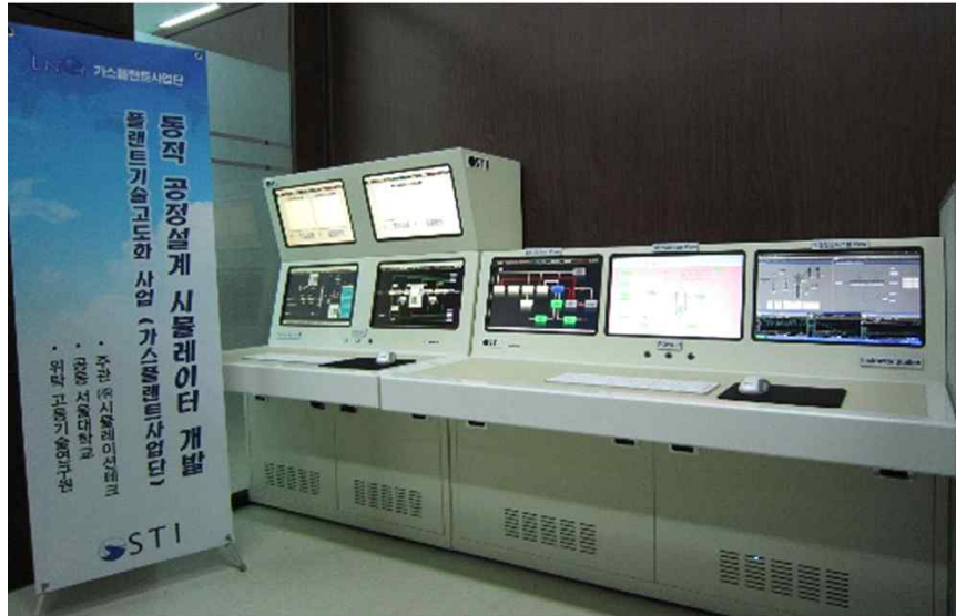
그림 2-6. LNG 액화 설비 동적 공정 시뮬레이터 개발 사례
