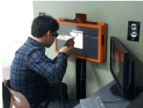
그림 1-8. 가상 용접 훈련 시뮬레이터 (토탈소프트뱅크)
