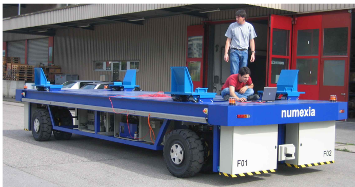
그림 2-3. 유도급전을 적용한 스위스 Numexia사의 컨테이너 수송용 차량
