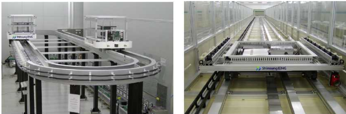
그림 2-9. 한국전기연구원이 개발한 30kW급 CPS
