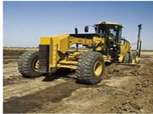
[그림 22] 3D-MC mmGPS 모터그레이더
