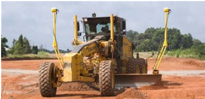
[그림 18] GCS900 on a Motor Grader with Dual GPS
