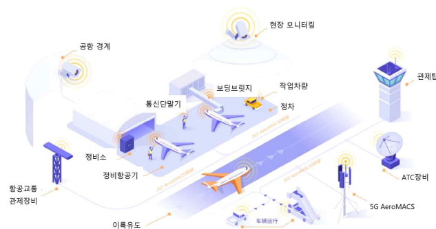
[그림] 5G AeroMACS 통신망 운용 개념도
