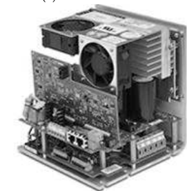
(d) DC Power Controllers
