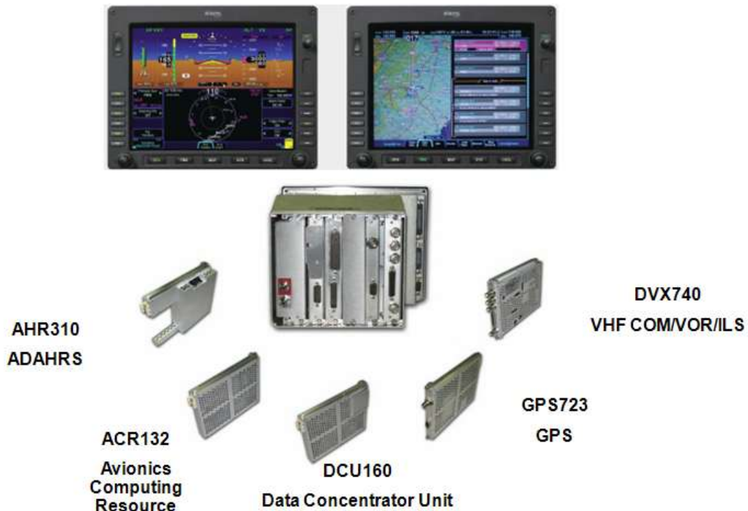
그림 10. KC-100 IFD 구성 모듈 및 전시화면 구성
