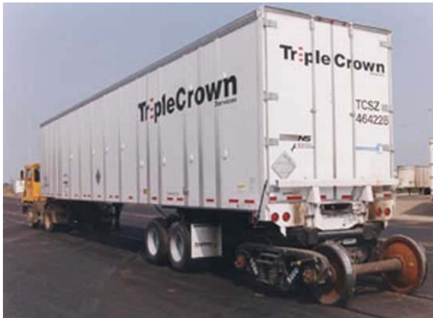
<철도를 위해 Bogie가 설치된 Bimodal>
