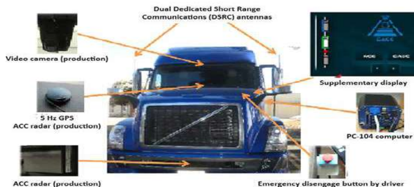
<그림 44> 군집차량에 탑재된 센서 및 시스템 구성
