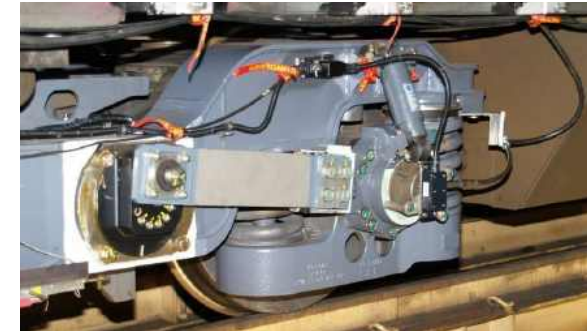
그림 2-2-3-24 FLEXX Tronic technology 응용 시제 대차
