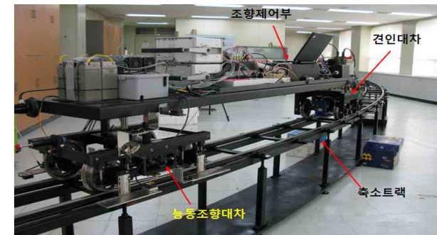
그림 2-2-3-38 능동조향대차 축소모델 시험시스템
