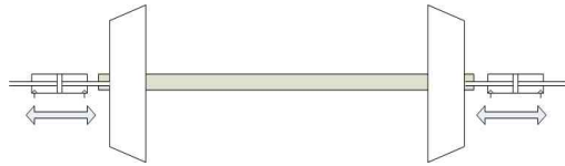
그림 2-2-3-11 횡방향 액추에이터를 이용한 조향방법
