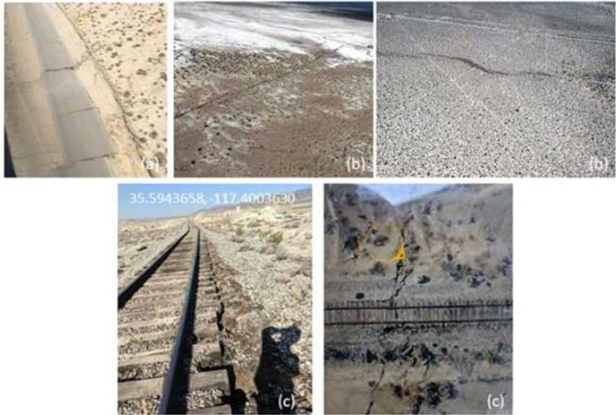
그림 46. (a) 차이나레이크 NWAS 기지에서 1.83m (1.83m)의 우측 가로 (RL)와 3 피트 (0.91m)의 수직 오프셋, (b) 노스 웨스트 트렌드 고장 파열 중국 호수 NWAS 기지의 오른쪽 - 외측 오프셋 6 피트 (1.83 m) 측정, 그리고 (c) RL 오프셋의 3 피트 (0.91 m)에 가까운 결함 파열로 인한 구부러진 철도 트랙.
