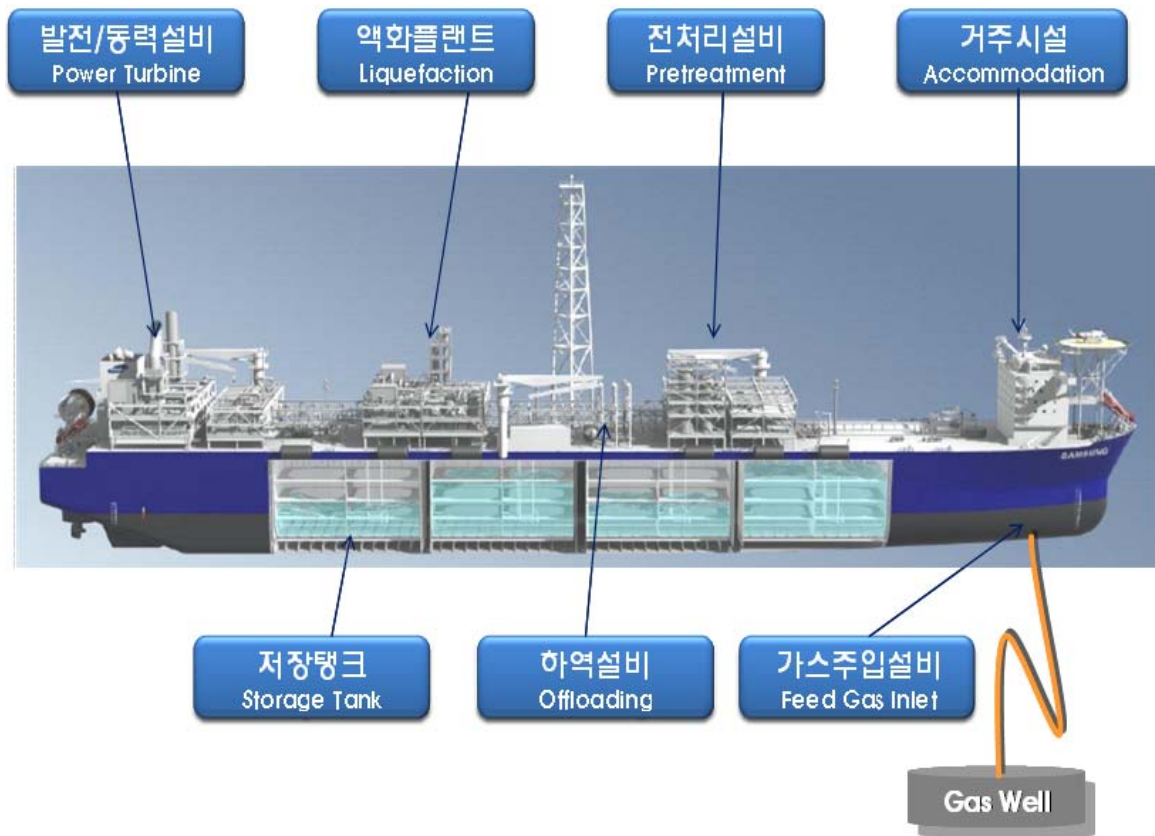
[그림 2.6] LNG-FPSO 설비배치 개략도
