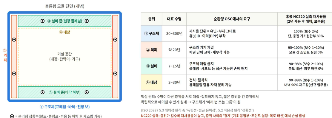
[그림] OSC 모듈의 층위 분리 개념과 홍콩 NC220 해체 후 층위별 재사용률
