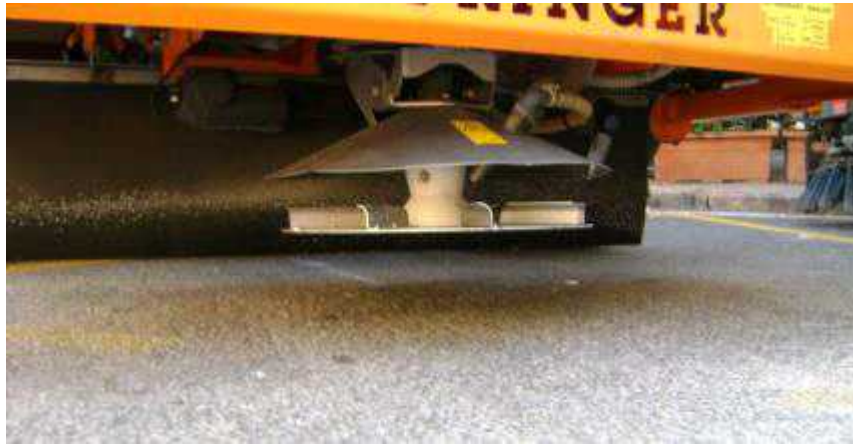
사진 2. 먼지비산억제제의 차량을 이용한 도로살포 (예방적조치들은 먼지입자의 축적을 막고, 저감조치들은 입자의 이동성을 감소시킨다.)
