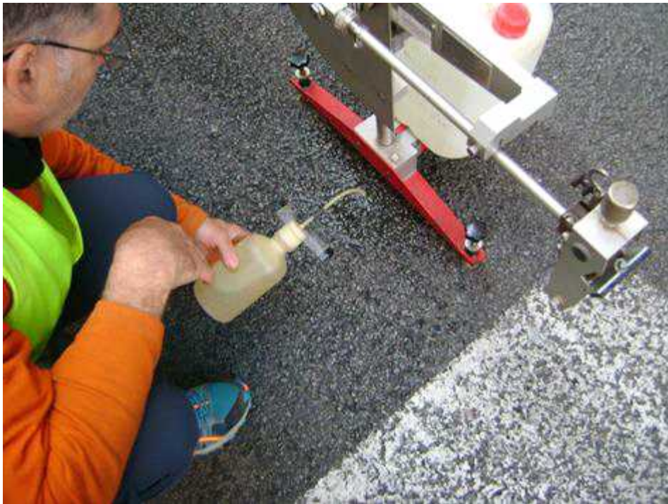
사진 3. CMA용액 포장면 테스트(CMA용액이 다량 사용될 경우, 포장면과 타이어의 마찰력을 저하시키는 효과가 나타나며 이에 따른 안전조치가 뒤따라야 한다)
