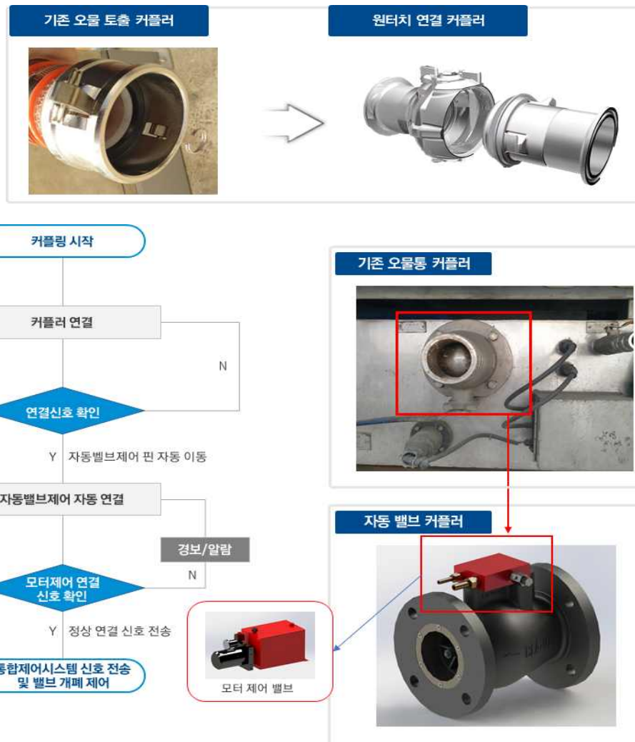
<그림 19> 기존 오물 토출 커플러 및 자동 밸브 커플러
