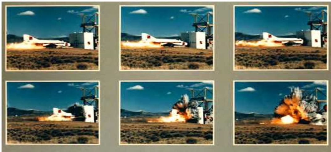
[그림 2-1] Sandia National Lab. 실규모 전투기 충돌 실험
