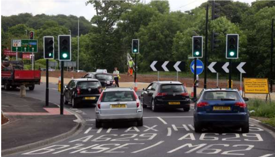
[그림 3-8] 진입제어 신호등 해외 설치 사례(잉글랜드, Huddersfield)
