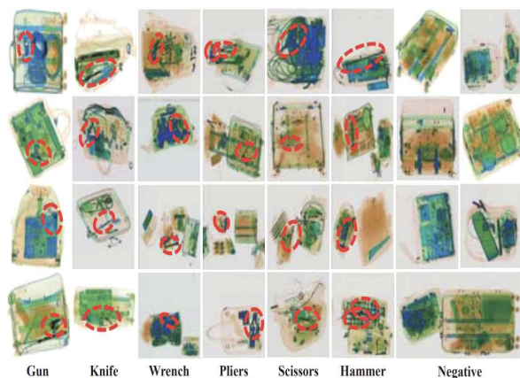
[그림] SIXray 벤치마크6대 위해물품 탐지 예시 및 투과 중첩 화물X-ray 영상 구조
