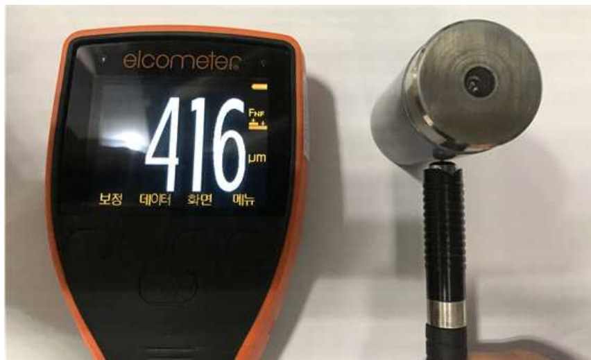
그림 59. 코팅 두께 측정 결과 (Coating thickness: 416 \mu\text{m} )
