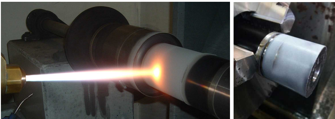
그림 12. 용사코팅 (Thermal Spray)을 이용한 Passive 센서 제작 과정
