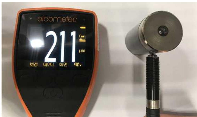
그림 57. 코팅 두께 측정 결과 (Coating thickness: 211 \mu\text{m} )
