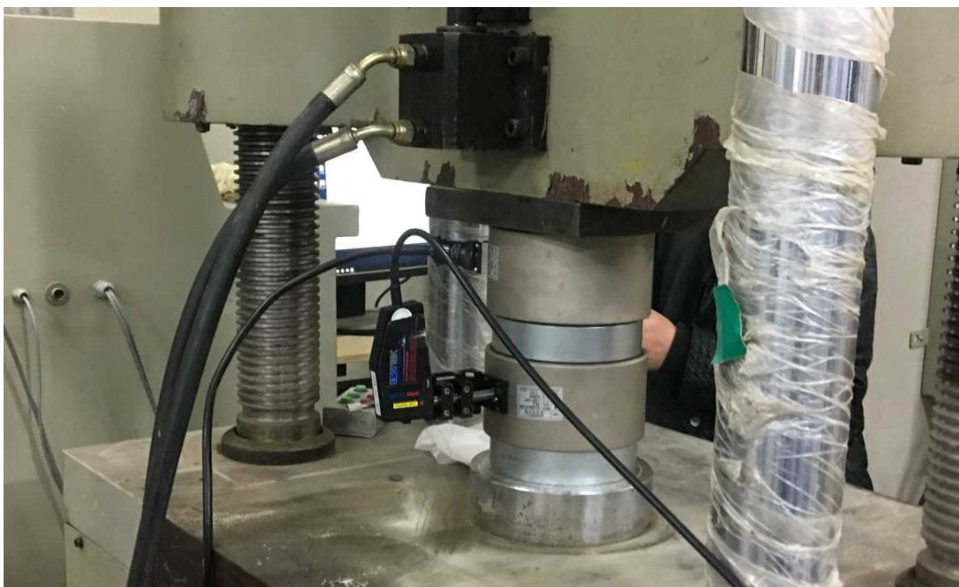
그림 40. 압축로드셀형 Passive 센서 시험
