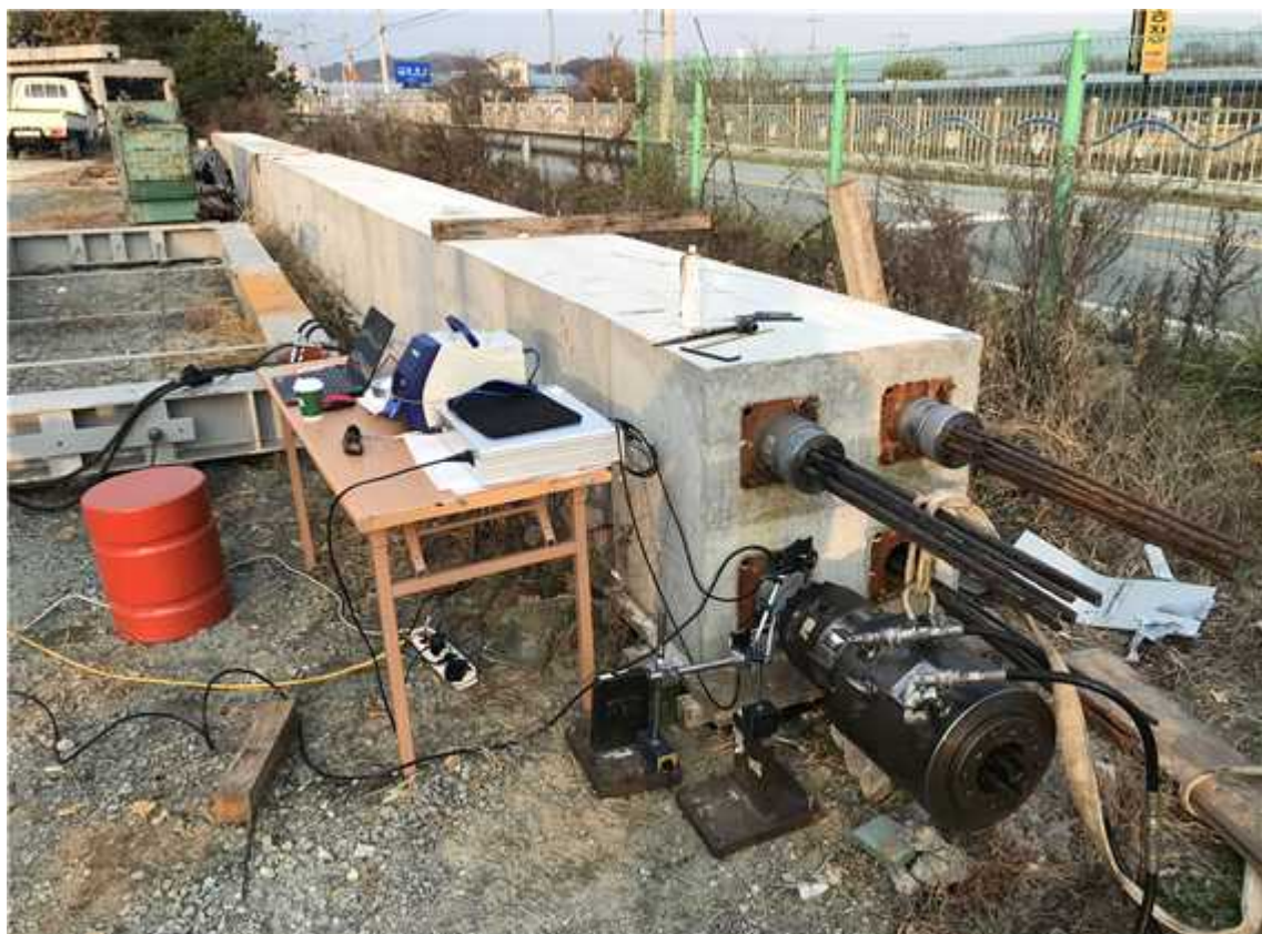
그림 111. PSC 박스교 25m 실대형 시험체 시험 구성 전경
