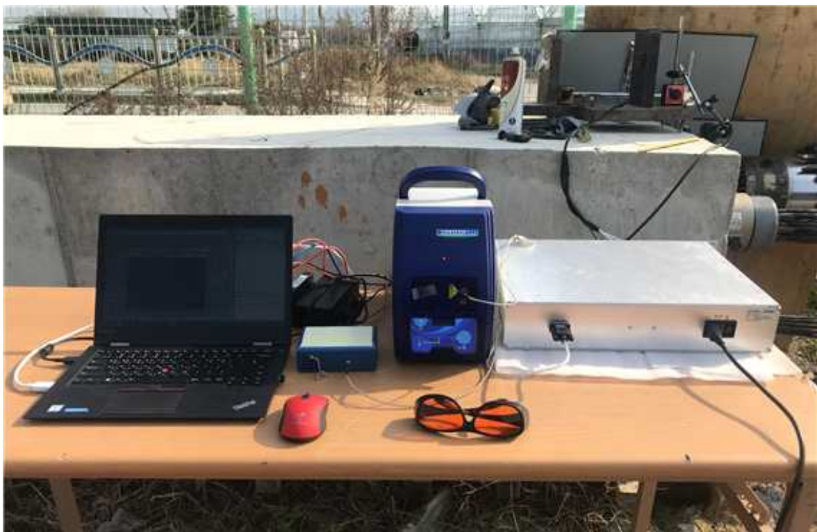
그림 113. 실험에 사용된 형광 분광 시스템 (좌측부터 컴퓨터, 형광분광기, 레이저, 광분배기)
