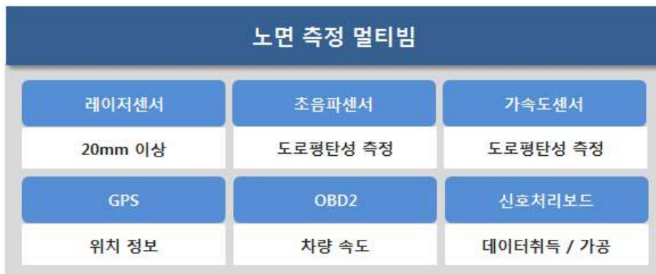
그림 13 노면 측정용 멀티빔 구성도
