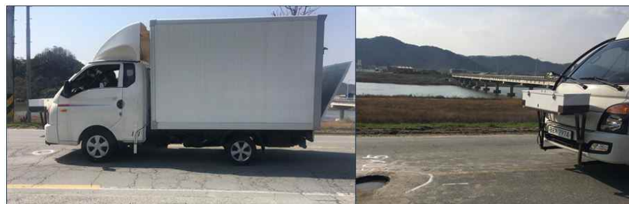
그림 78 노면 포트홀 및 도로 평탄성 스캔
