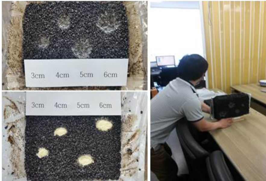
그림 14 포트홀 시편(좌) 및 센서 포트홀 감지 실험(우)
