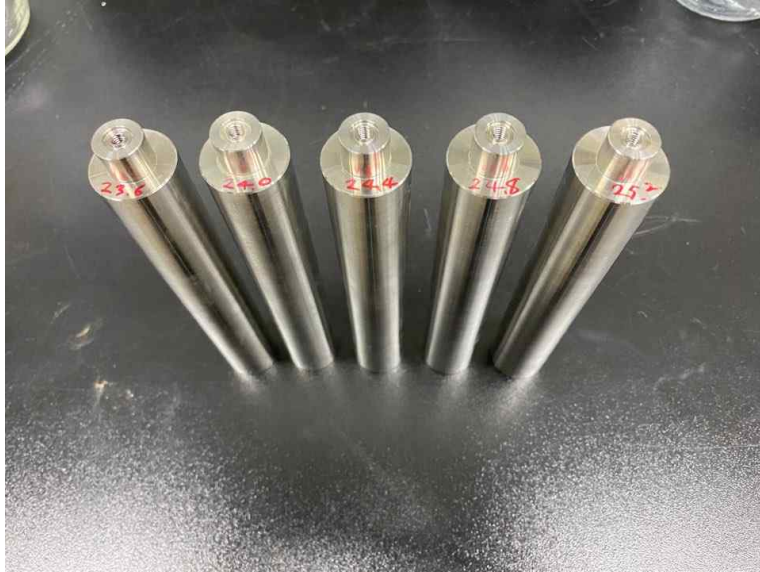
그림 25. 직경이 각기 다른 내부 전극 (좌측부터 직경 사이즈: 23.6mm, 24.0mm, 24.4mm, 24.8mm, 25.2mm)
