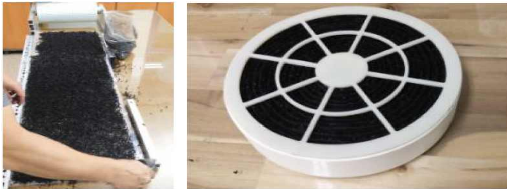
그림 17. 대나무 활성탄 정전 필터 제작 과정 및 프로토타입 (출처: 중소기업 기술개발사업 최종 보고서, 2018)
