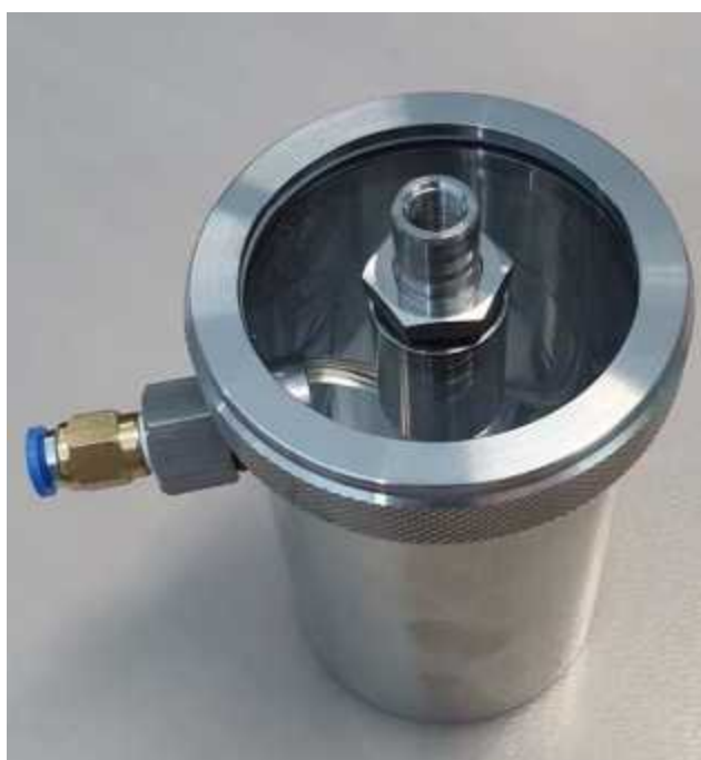
그림 22. 미세먼지 발생장치 Atomizer
