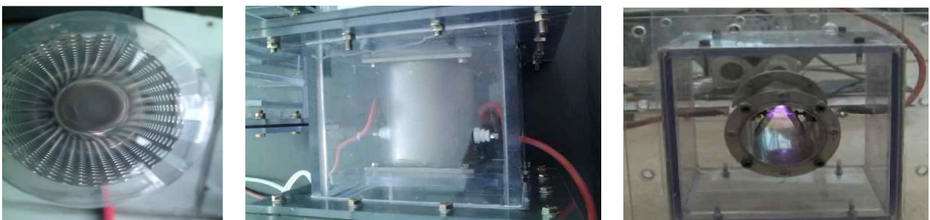
그림 15. SAP(좌)와 CDBD(중) 반응기 및 플라즈마 운전(우) (출처: 최종 보고서_플라즈마를 활용한 실내공기질 개선 솔루션 개발, 2011)
