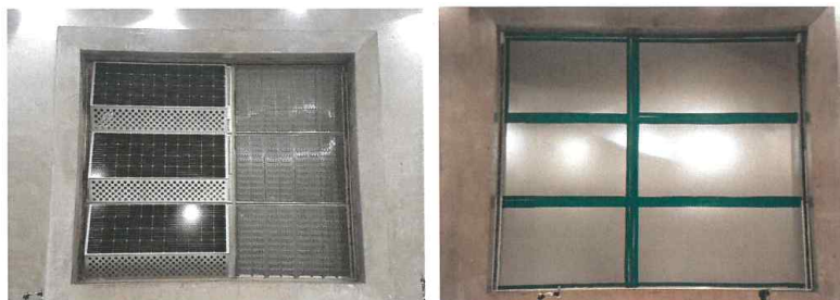
[그림 24] 음원실(좌), 수음실(우) 실험체 설치 모습
