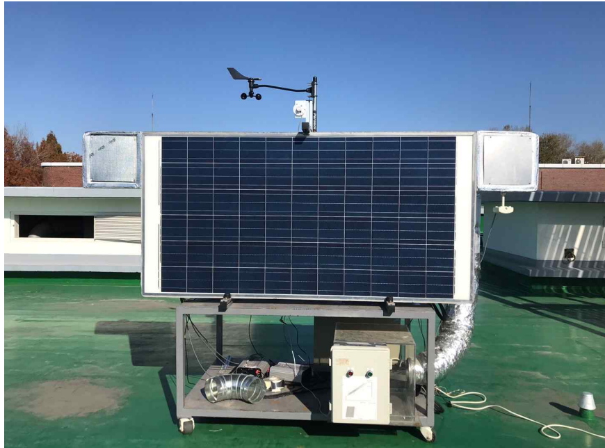
[그림 40] PVT 방음 모듈 열, 전기 성능 시험 장치
