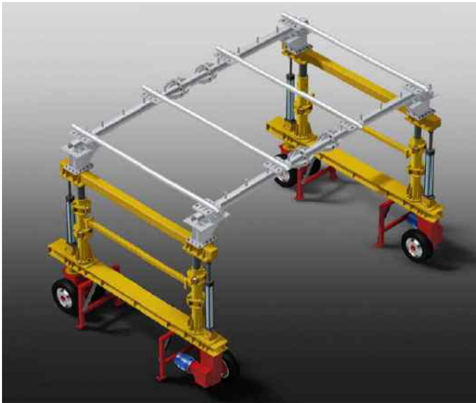
<그림 12-4 입체트러스 조립도 (측벽작업대, 안전망, 구동부 충돌 보호대 등은 안보여짐)>
