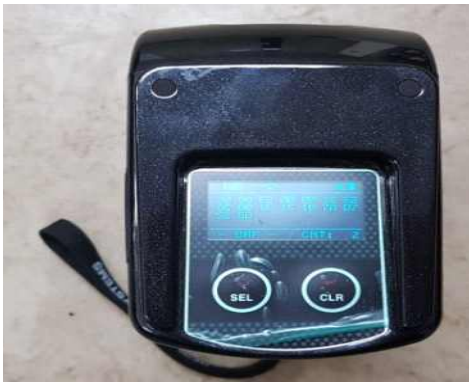
그림 3.94 RFID UHF 휴대용 리더기 외관 및 LCD 구현
