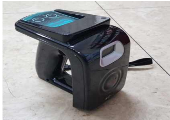
그림 3.94 RFID UHF 휴대용 리더기 외관 및 LCD 구현
