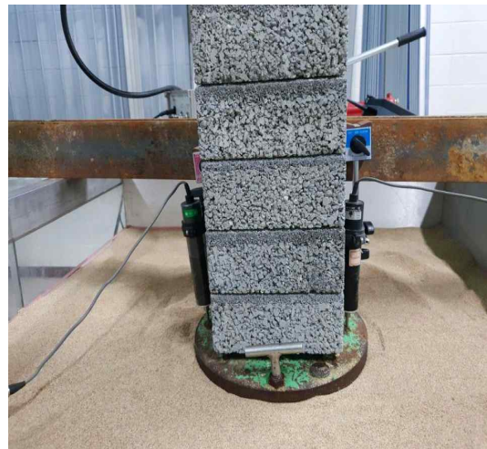
(f) 재하관 설치 및 평판재하시험
