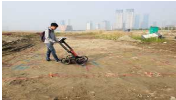
(f) GPR 탐사 전경
