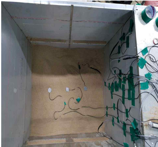
(a) 하부 토압계 설치
