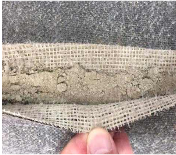
그림 3.21 시멘트 매트 PET보강메쉬 적용(상하 2 layer) 모습
