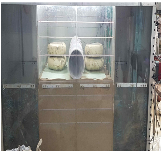
(e) 팽창매트 설치
