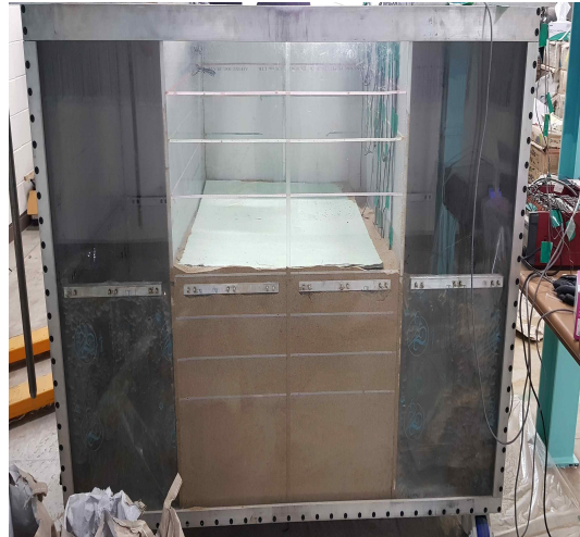
(b) 시멘트매트 설치
