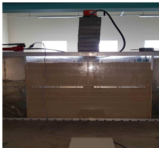
(f) 재하판 설치 및 평판재하시험
