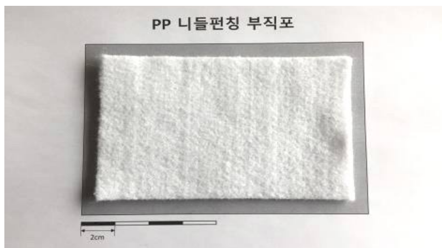
그림 3.3 PP 니들펀칭 부직포 섬유커버재 샘플 사진
