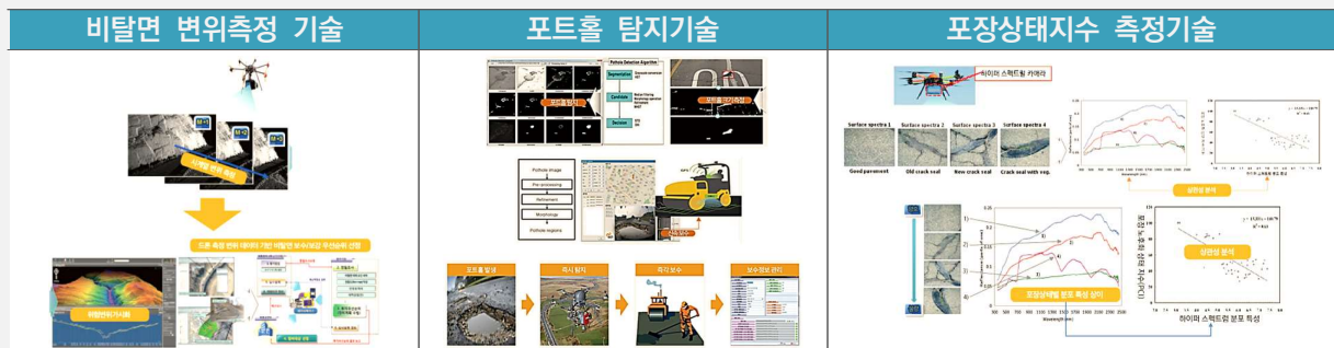
[그림 II-18] 드론을 활용한 도로 현황 측정 기술
