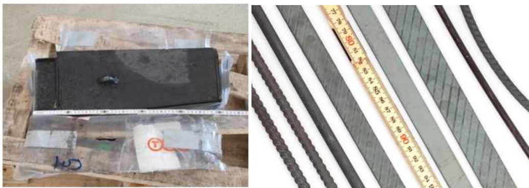
<batch size 주강괴 및 이를 통한 소성가공 시제품 제작 사례>
