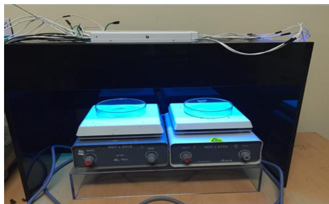
그림 3.2.59 Petri dish를 이용한 메틸렌블루 제거실험 예 (좌: \text{TiO}_2 , 우: TCZ)
