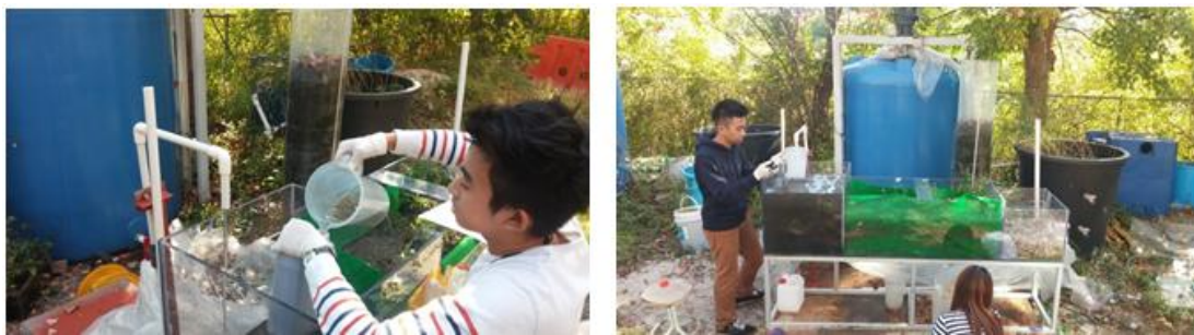
그림 3.1.36 실제 강우유출수 주입 및 유량 확인 모습
