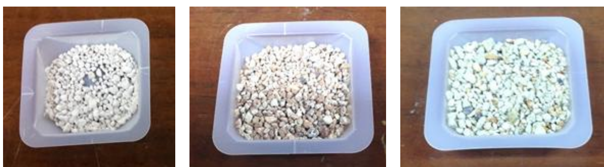
그림 3.2.42 열처리법으로 광촉매가 코팅된 제올라이트 여재 (왼쪽부터 \text{TiO}_2 코팅 제올라이트, \text{WO}_3/\text{TiO}_2 코팅 제올라이트, 코팅하지 않은 제올라이트)
