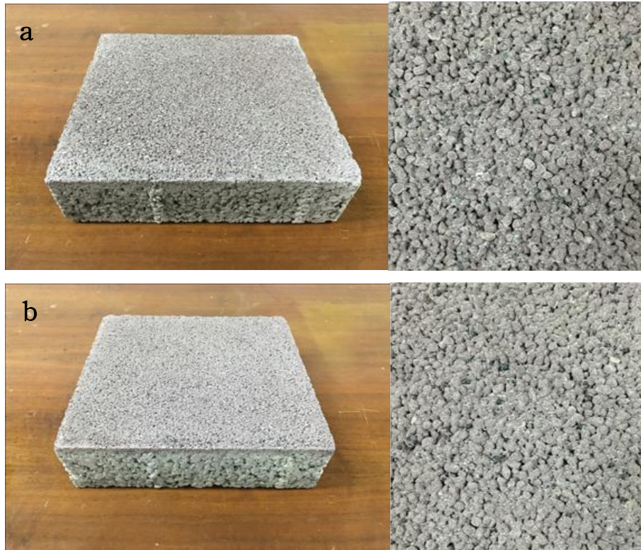
그림 3.2.46 광촉매 코팅 콘크리트 투수블럭: (a) \text{TiO}_2 코팅 투수블럭 (b) \text{WO}_3/\text{TiO}_2 코팅 투수블럭
