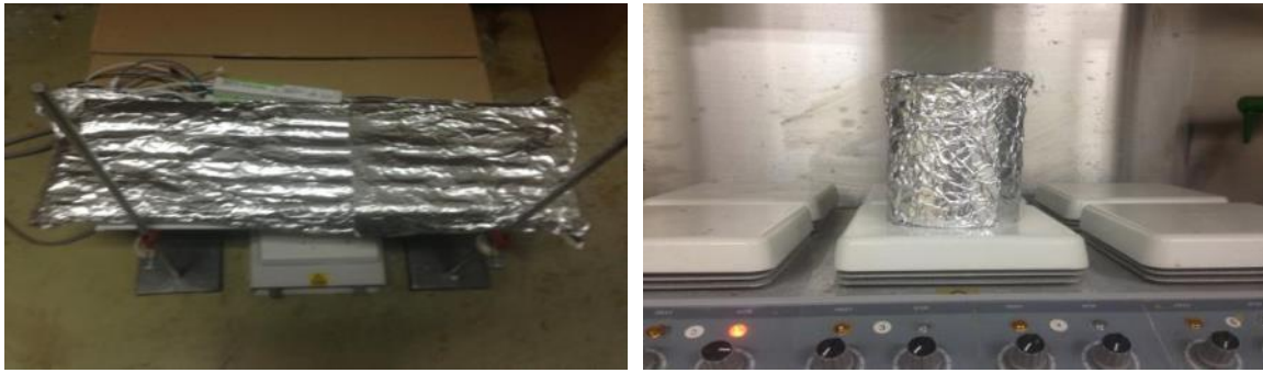
그림 3.2.58 비커를 이용한 수중의 메틸렌블루 제거 배치실험 장면 (좌: 광원을 조사한 경우, 우: 광원을 조사하지 않은 경우)
