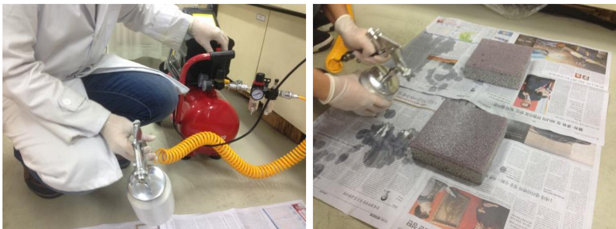
그림 3.2.45 콘크리트 투수블럭 표면에 광촉매를 코팅 하는 장면
